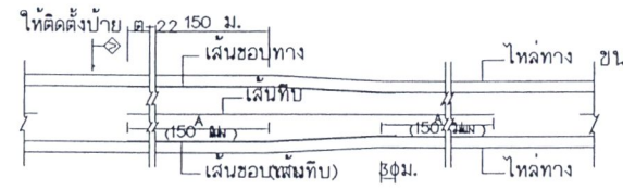
การตีเส้นจราจร กรณีความกว้างของช่องจราจรลดลง
